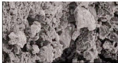
Vergrößerung des unbehandelten Betons 200x
